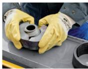
Vom Einspannen der Welle mit Schneckenelementen in das Abziehsystem über die Montage von Alu-Halbschalen vor dem Abzieh-Vorgang, die Entnahme des abgezogenen Schneckenelements bis hin zur fertigen, neuen Bestückung.
