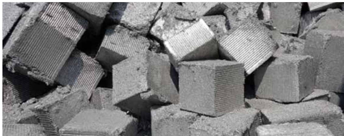
Presspakete aus (ursprünglich) losem Reifendraht
